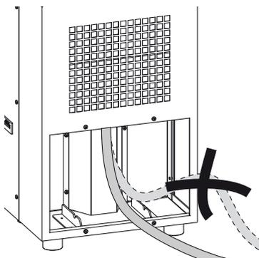
Entfernen Sie den Schlauch, wenn Sie den Kondensat wieder über den Kondensatbehälter auffangen wollen. Lassen Sie den Schlauch vor der Lagerung trocknen. Der Schlauch kann in jeder beliebigen Betriebsart zum Dauereinsatz angeschlossen werden.
