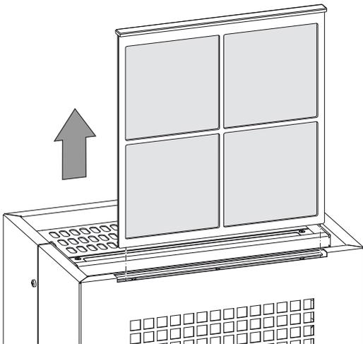
2. Säubern Sie den Filter mit einem weichen, fusselfreien, leicht angefeuchteten Tuch. Sollte der Filter stark verschmutzt sein, säubern Sie ihn mit warmem Wasser, vermischt mit neutralem Reinigungsmittel.
