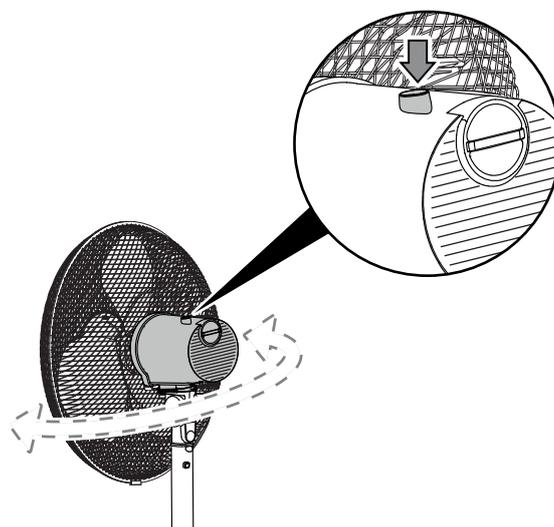
1. Pressionar de novo o perno da oscilação (7) para desligar novamente a oscilação.
